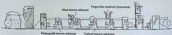
9.2.6-rasm. Fleksografik, ofset va trafaret bosma, shuningdek, zar bilan qaynoq qisish relefli qisish texnologiyalarini birlashtirgan, etiketkalarini bosishga mo'ljallangan gibrid bosma tizimi (CombiPrint, Goebel)
