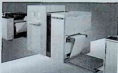
5.5.51-rasm. Qog'oz matosida raqamli bosma uchun magnitografiya tizimi; imkonilik qobiliyati 480 dpi, tezlik 1 m/s (Nipson 7000)
