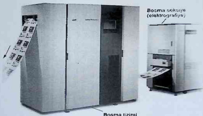
9.2.8-rasm. Elektrofotografiya (bir rangli rulonli bosish) va ko'p bo'yoqli nusxalar uchun purkashli bosma texnologiyalarini birlashtirgan gibrud bosma tizimi (Info Print 4000; Info Print Highlight Color, IBM)
