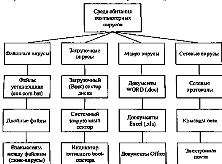
Рис. 7.6. Классификация компьютерных вирусoв по среде обитания
