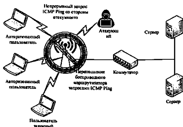
Рис.5.7. Осуществление DoS-атаки на беспроводную сеть
